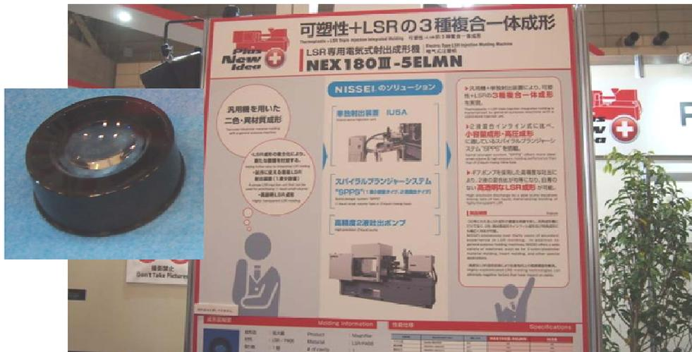
図2. 日精樹脂の熱可塑性樹脂+液状シリコンの 3 種複合一体成形の説明パネルと成形品
