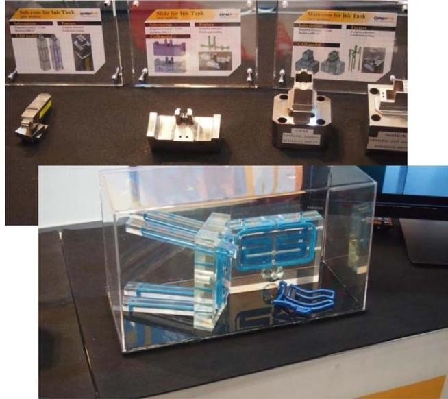
図18. OPM ラボラトリーブースに展示されていた金型入れ子・スライドと配管がわかりやすい模型
