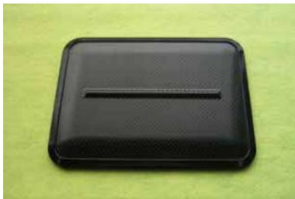
図4. 日本製鋼所ブースで成形実演していた炭素長繊維強化シートのインサート成形品
