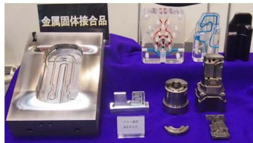
図19. 拡散接合による三次元冷却回路の展示(上:積層金型、下:モールドアクト)
