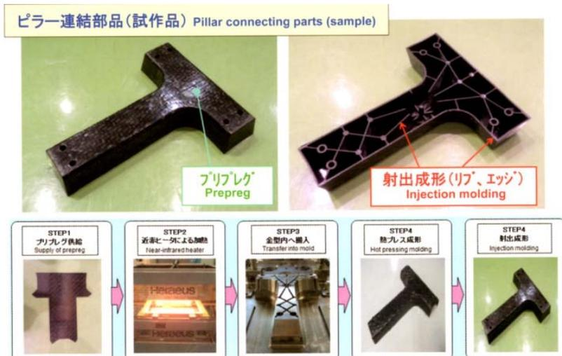
図5. 東芝機械(株)ブース配布資料に示されたオーガニックシートの インサート成形
