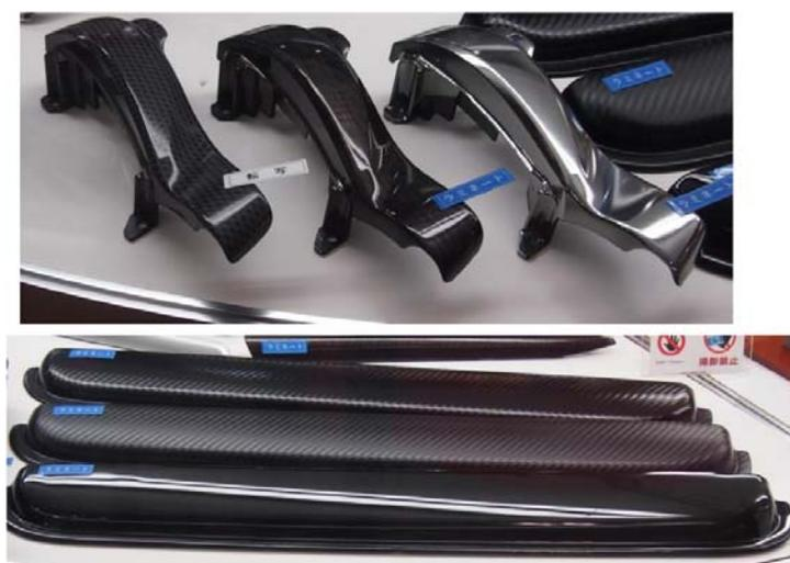
図23. ナビタスブースに展示されていた空気転写工法による転写およびラミネートサンプル
