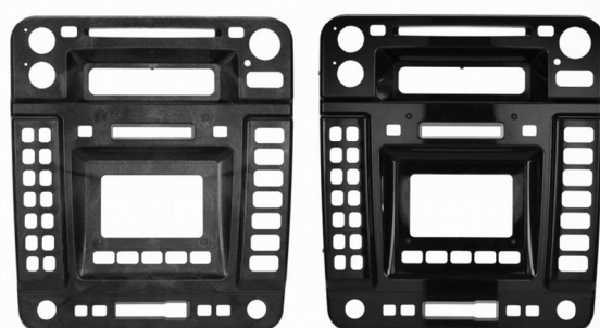
図14 センターパネルテスト型による成形サンプルの外観 左: 微細射出発泡成形 (MuCell) 右: 微細射出発泡成形と金型加熱冷却の組み合わせ (MuCell Gloss)
