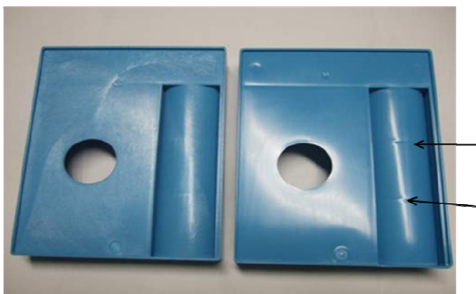
図7 ポリプロピレン成形品のヒケの様子 左：微細射出発泡成形 (MuCell)、右：通常射出成形 東芝機械(株)技術資料
