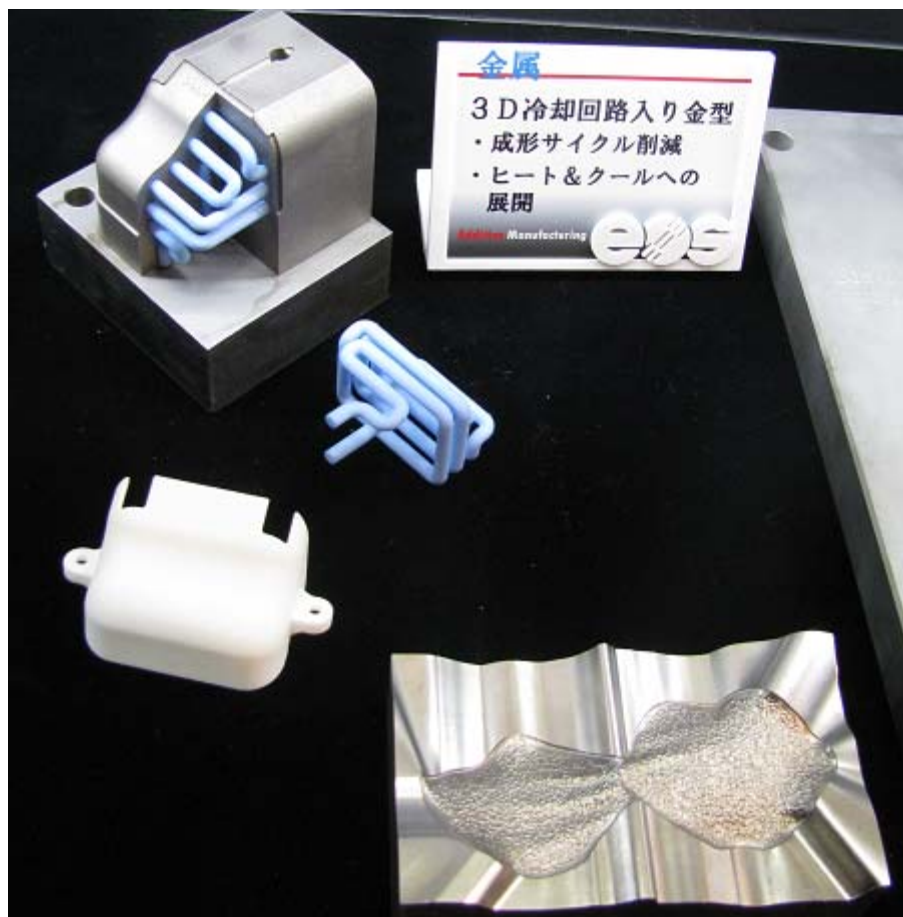
図8 金型の模型（三次元冷却配管、シボ面）(NTT データエンジニアリングシステムズ株)
