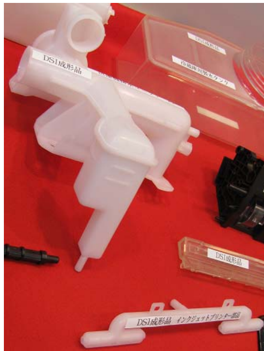
図4 DSI による成形品（第一樹脂工業株）
