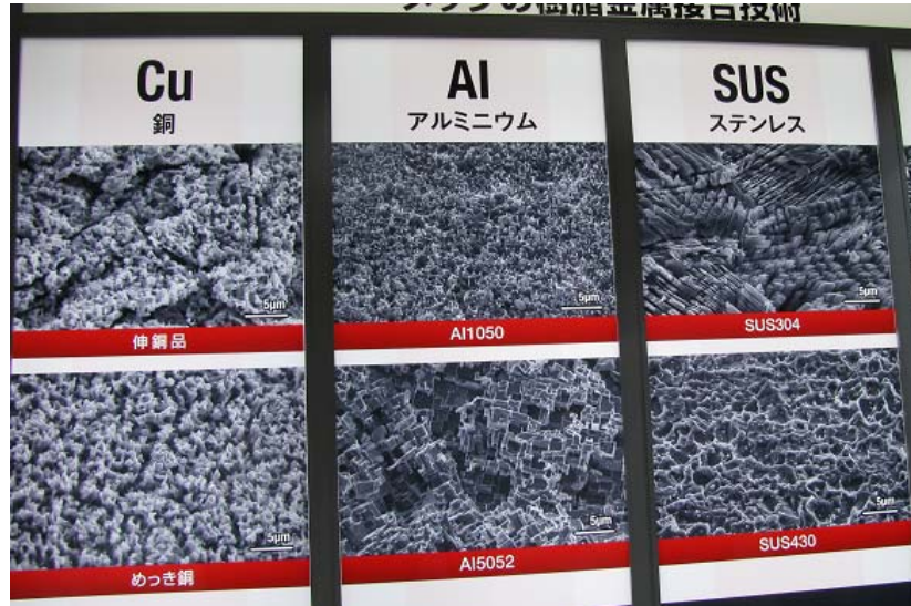
図3 金属の表面処理による表面多孔化の様子を説明したパネルの一部（メック株）
