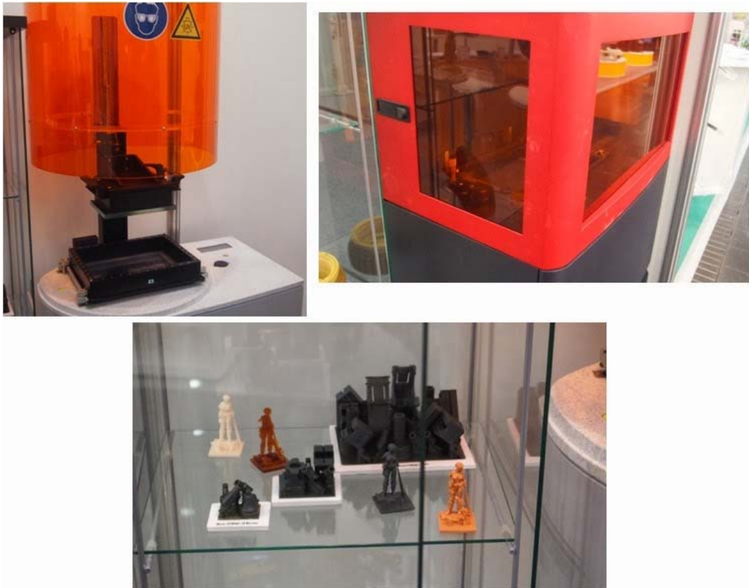
図7 envisionTEC ブースに展示されていた光造形装置（上2台）と造形品サンプル(下)
