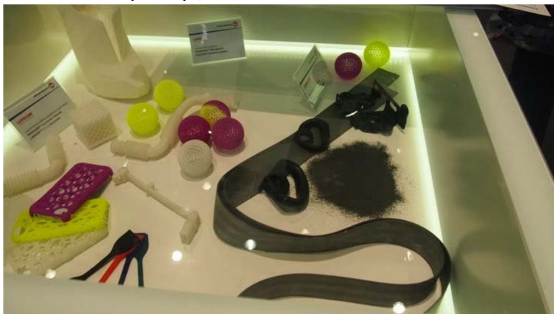
図5 ウレタン樹脂粉末 LUVOCOM による造形品サンプル
