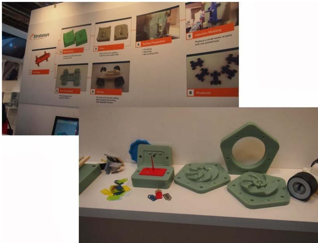
図2 Stratasy's ブースのパネルとインクジェット法で造形された樹脂製「金型」及び成形品
