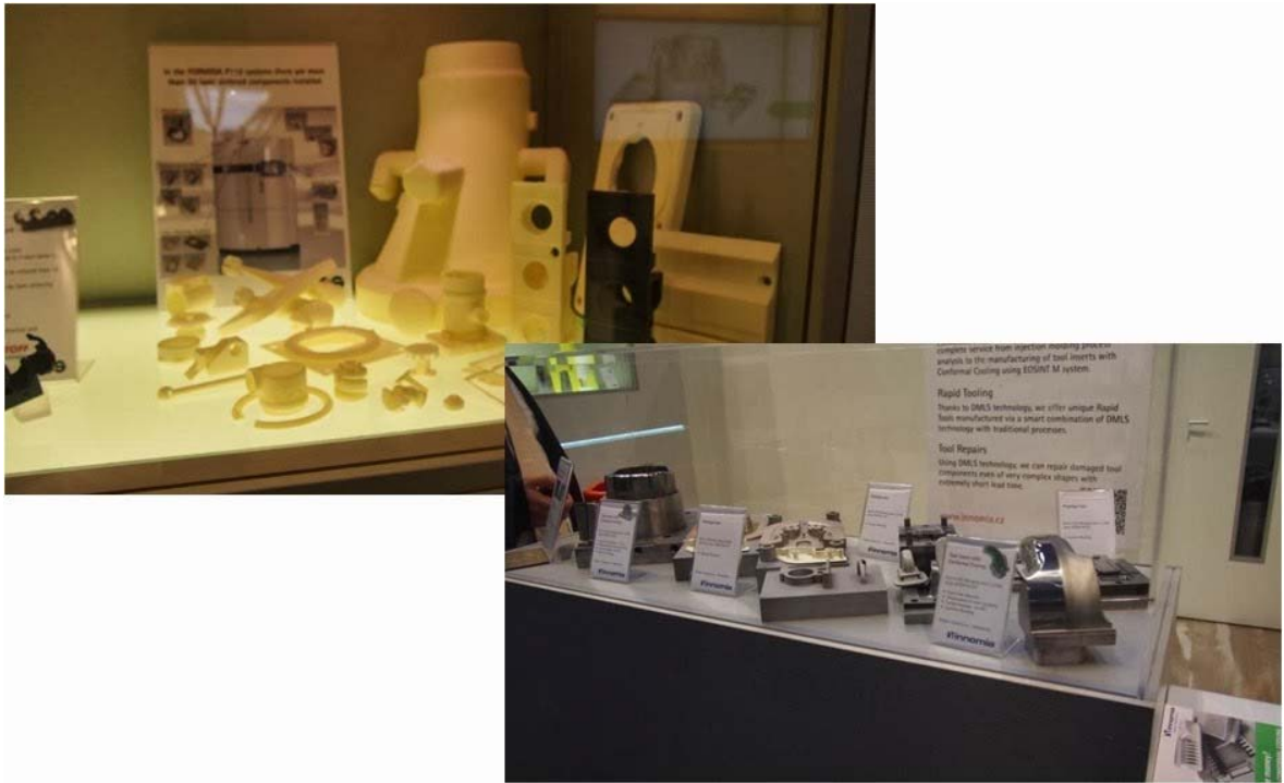
図6 EOSブースに展示されていた樹脂粉末による造形品（左上）とパートナー企業による金属粉末造形品（金型入れ子）
