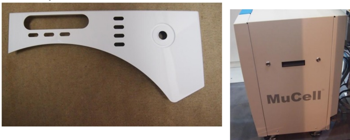
図3 . KraussMaffei ブースで成形実演されていた高光沢発泡成形品（左）と新型超臨界流体発生・供給装置（右）
