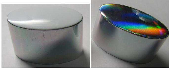
図10 村田金箔のブースで実演していたホットスタンプによる加飾サンプル
