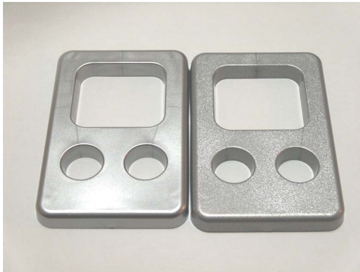
図11 アルミフレーク添加により金属調に仕上げた成形品 左:粒子径 20 \mu\text{m} のアルミフレーク使用、右:粒子径 60 \mu\text{m} のアルミフレーク使用
