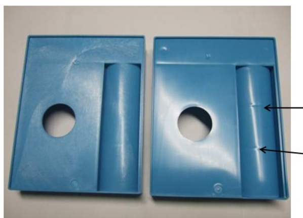
図6. ポリプロピレン成形品のヒケの様子 左：微細射出発泡成形 (MuCell)、右：通常射出成形 (東芝機械殿提供)
