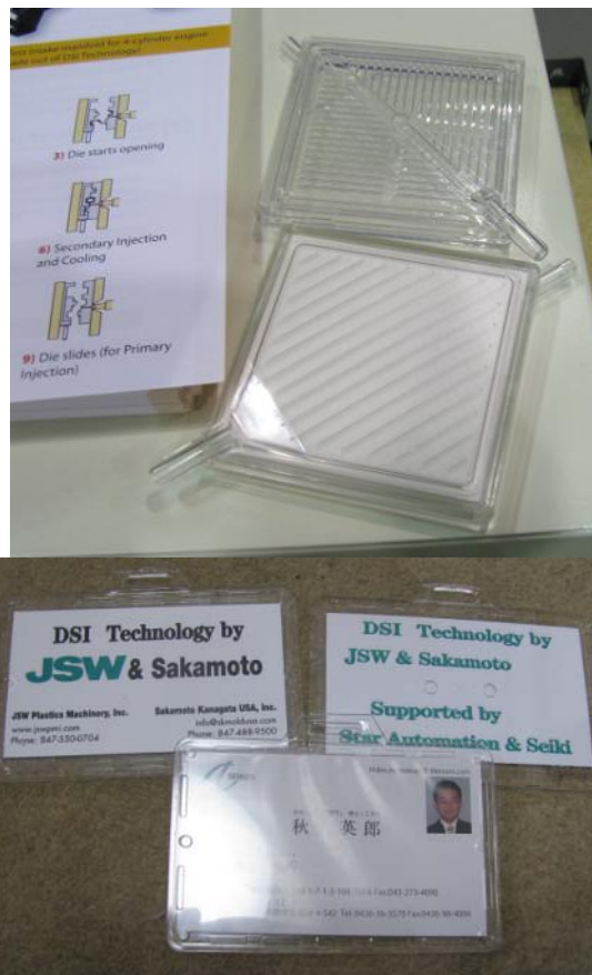
図11 日本製鋼所のブースで DSI によって成形していた名刺インサート成形品 (右) と医療用フィルターのサンプル (左)
