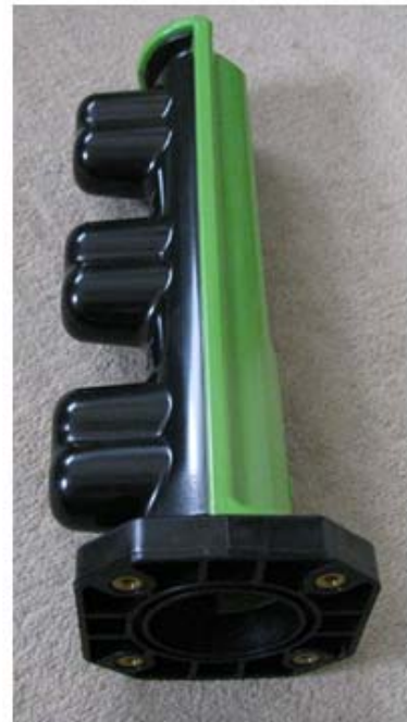
図4 ENGEL のブースで成形していたサンプル 右:二色成形+インモールドラベル、左:金属インサート+三色成形
