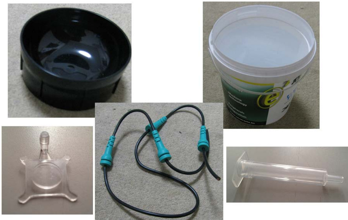
図3 ARBURG のブースで成形していたサンプル 左上:ボウル、右上:バケツ(インモールドラベル+取っ手取り付け) 左下:微細転写、中央下:ケーブルインサート、右下:シリンジ
