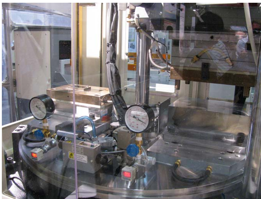
図13 日精樹脂工業のブースで実演していた縦型成形機に PC シートインサートによるバッテリーケースの成形
