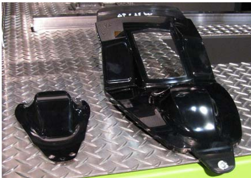
図5 ENGEL のブースで成形していたセンターコンソール（右）と 回路が形成されたインサート部品（左）
