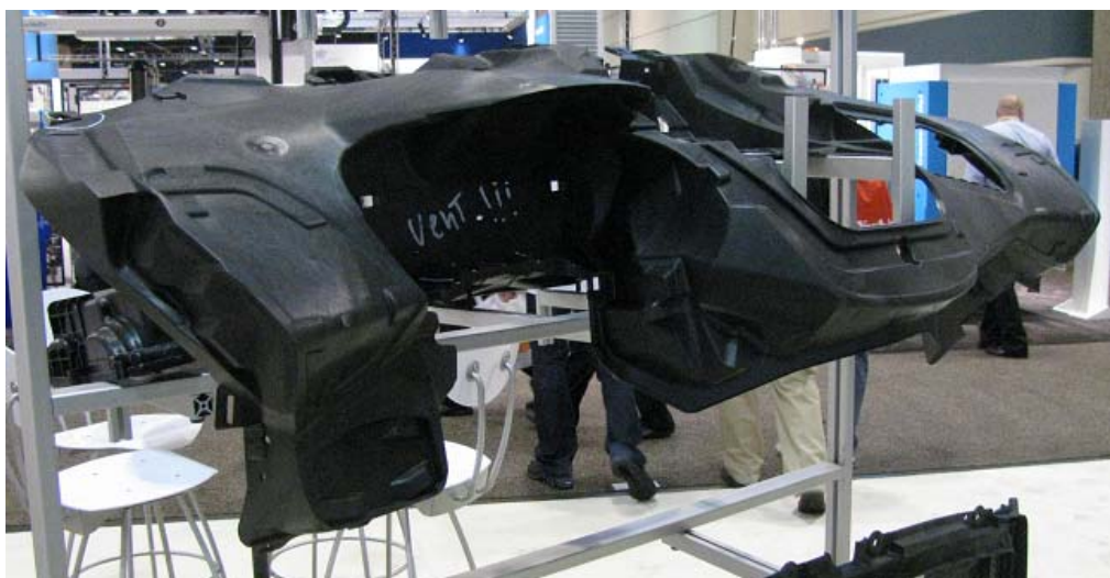
図17 TREXEL ブースに展示されていた微細射出発泡成形 (MuCell) で成形されたインパネ
