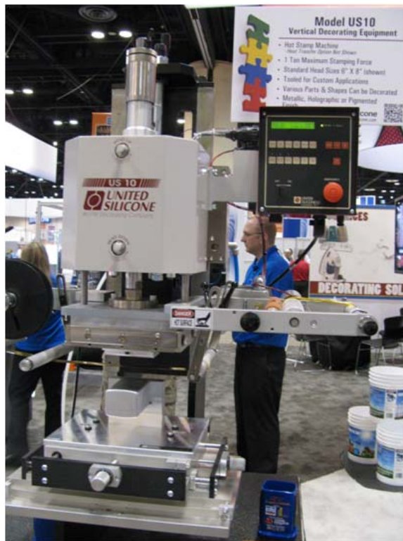
図27 United Silicone の熱転写装置と加飾サンプル
