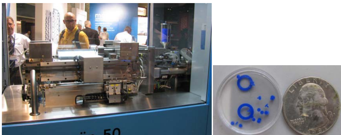
図15 Manner のブースで実演していた小型射出成形機と成形品
