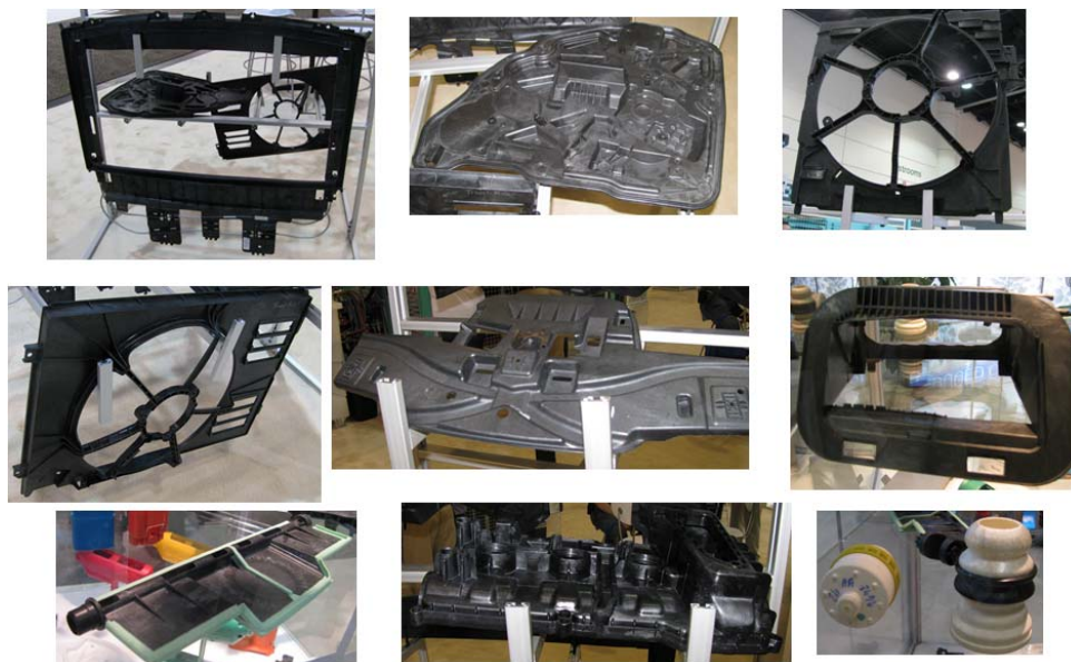
図18 TREXEL のブースに展示されていた MuCell による自動車部品のサンプル
