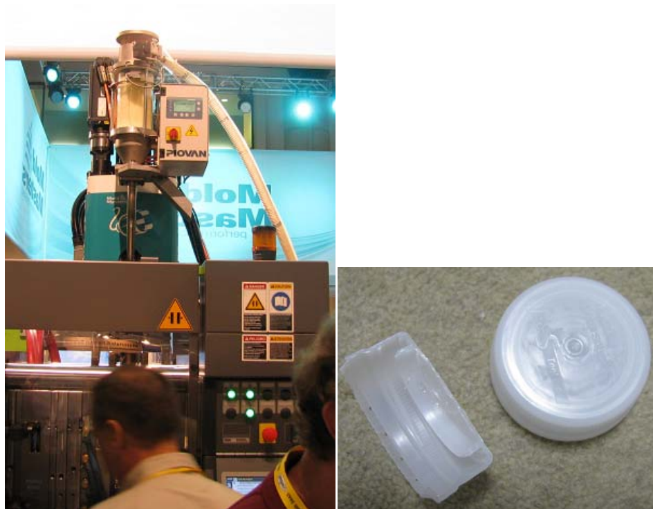
図16 モールドマスターズのブースで実演していた IRIS システム (左) を用いた コインジェクション成形とガスバリア性キャップ (右)
