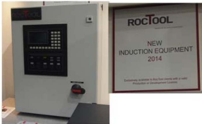
図 1 . RocTool の小型化された電源ユニット (左) と説明パネル
