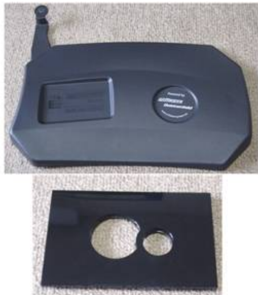
図7 . Wittmann Battenfeld のブースで成形実演されていたサンプル 上：発泡成形とヒート&クール（BF-MOULD）の組合せによる成形品 下：BF-MOULD によるピアノブラック成形品
