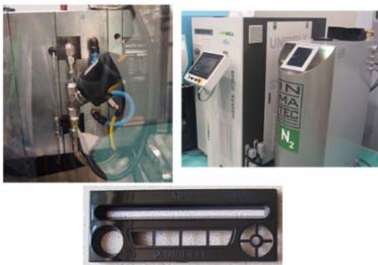
図6 . STIELER ブースで実演されていたガスプレスと emCo プロセスの組合せ 左上：大きなバルブを備えた金型、右上：emCo 及びガスプレス装置、下：ピアノブラック成形品
