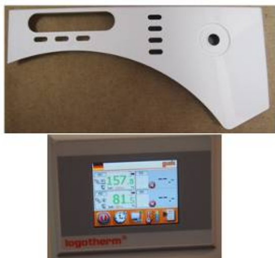
図5 . KraussMaffei ブースで成形実演されていた MuCell とヒート&クールの組合せ技術 上：成形品、下：gwk 温調装置の温度設定画面
